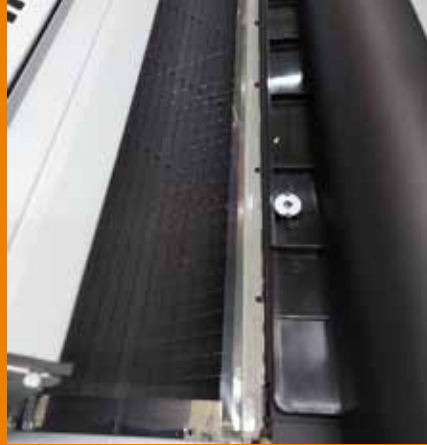
Die Radiant Fusing-Technologie, die in den Geräten der plotWAVE-Serie eingesetzt wird, spart Energie und gewährleistet die sofortige Verfügbarkeit für hochwertige Drucke. Im Bild: Die Fixiereinheit mit Heizlamellen.
