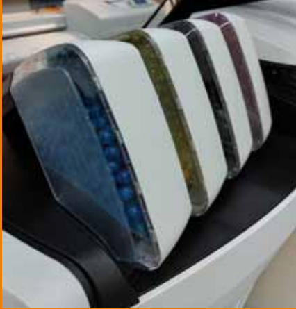
Durch den Einsatz innovativer TonerPearls, die erhitzt und präzise auf die Medien aufgespritzt werden, liefert die CrystalPoint-Technologie der colorWAVE-T-Reihe gestochen scharfe Druckqualität und vielseitige Medienkompatibilität.
